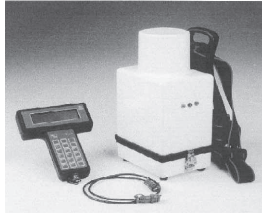
Foto Alat T VLF yang digunakan dalam pengukuran, terdiri dari : 1 unit sensor, Kontroler T dan Kabel penghubung antara kontroler dengan unit sensor
