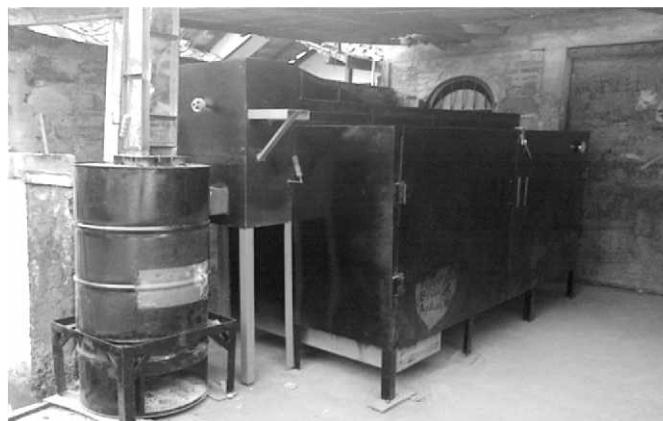
Gambar 3. Realisasi oven pengeringan kayu.
