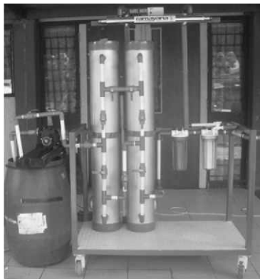
Gambar 2. Alat penjernih air dengan sistem filtrasi.
